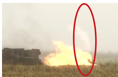
Essai de brûlage véhicule GNL (torchère en haut)
