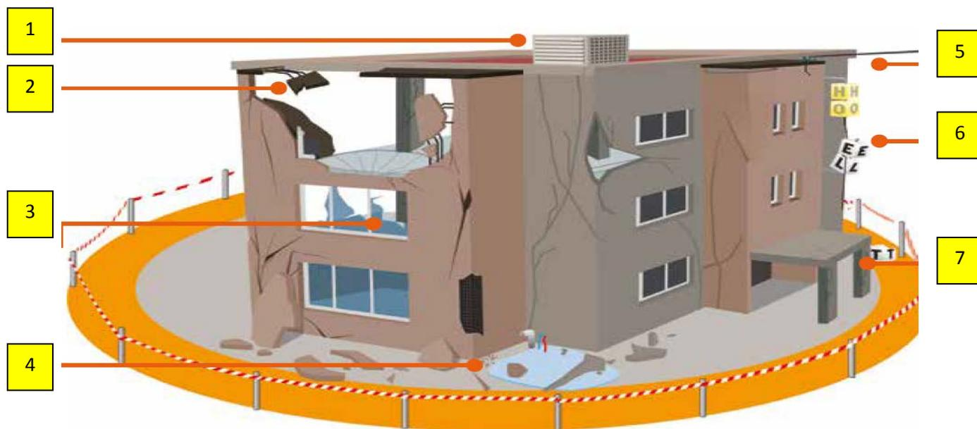
**1** : Des éléments lourds en toiture tels que des unités d'air conditionné ou des réservoirs d'eau peuvent tomber ou passer à travers les toits endommagés.
